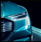
**Matrix LED HD** : Cette technologie innovante répartit le faisceau lumineux de façon optimale. Ceci permet d'éviter d'éblouir les conducteurs des véhicules qui vous précèdent ou arrivent en sens inverse tout en assurant un éclairage parfait des autres zones périphériques. La répartition de la lumière est garantie par l'activation et la désactivation de segments lumineux individuels. L'éclairage de la route est ainsi nettement amélioré ce qui signifie aussi plus de sécurité et de confort.
