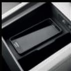
**Audi phone box** : compartiment situé sous le tableau de bord central, équipé d'un chargeur de téléphone par induction et d'un amplificateur de téléphonie. Lorsque votre téléphone y est placé, il se charge sans fil et son signal est amplifié en passant par l'antenne.
